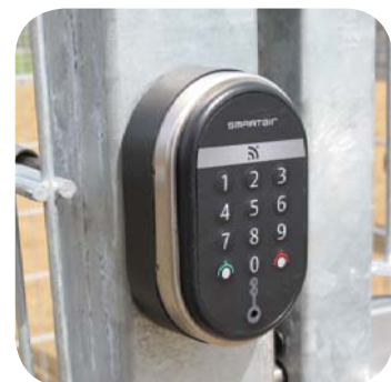
Onlinelæser monteret på gitterport
